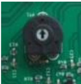
Poner el motor en marcha (Modo un solo pulsado), después girar el potenciómetro hasta "LIMIT", en el sentido inverso de las agujas de un reloj, para bajar la fuerza hasta el paro del motor.
